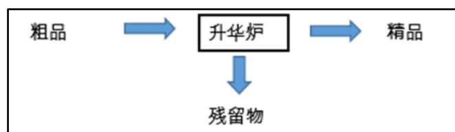
图 28 OLED 精品研发工艺流程及产污环节图
