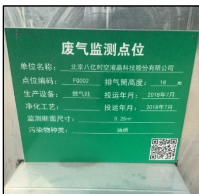
图 23 食堂废气排放口标识牌
