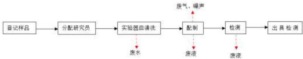
图 3 分析检测工艺流程及其产污环节
